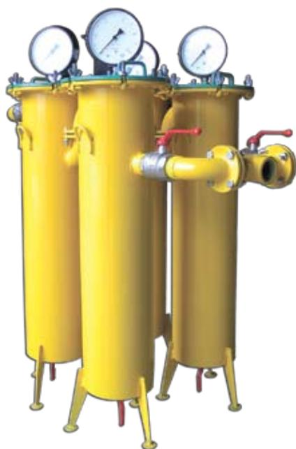
Фильтровальные установки предназначены для подготовки к закачке в скважину (очистки): солевых растворов, воды или других технологических жидкостей. Степень очистки зависит от концентрации взвешенных частиц входящей жидкости раствора и пористости фильтрующего элемента (50мкм; 25мкм; 5мкм).
