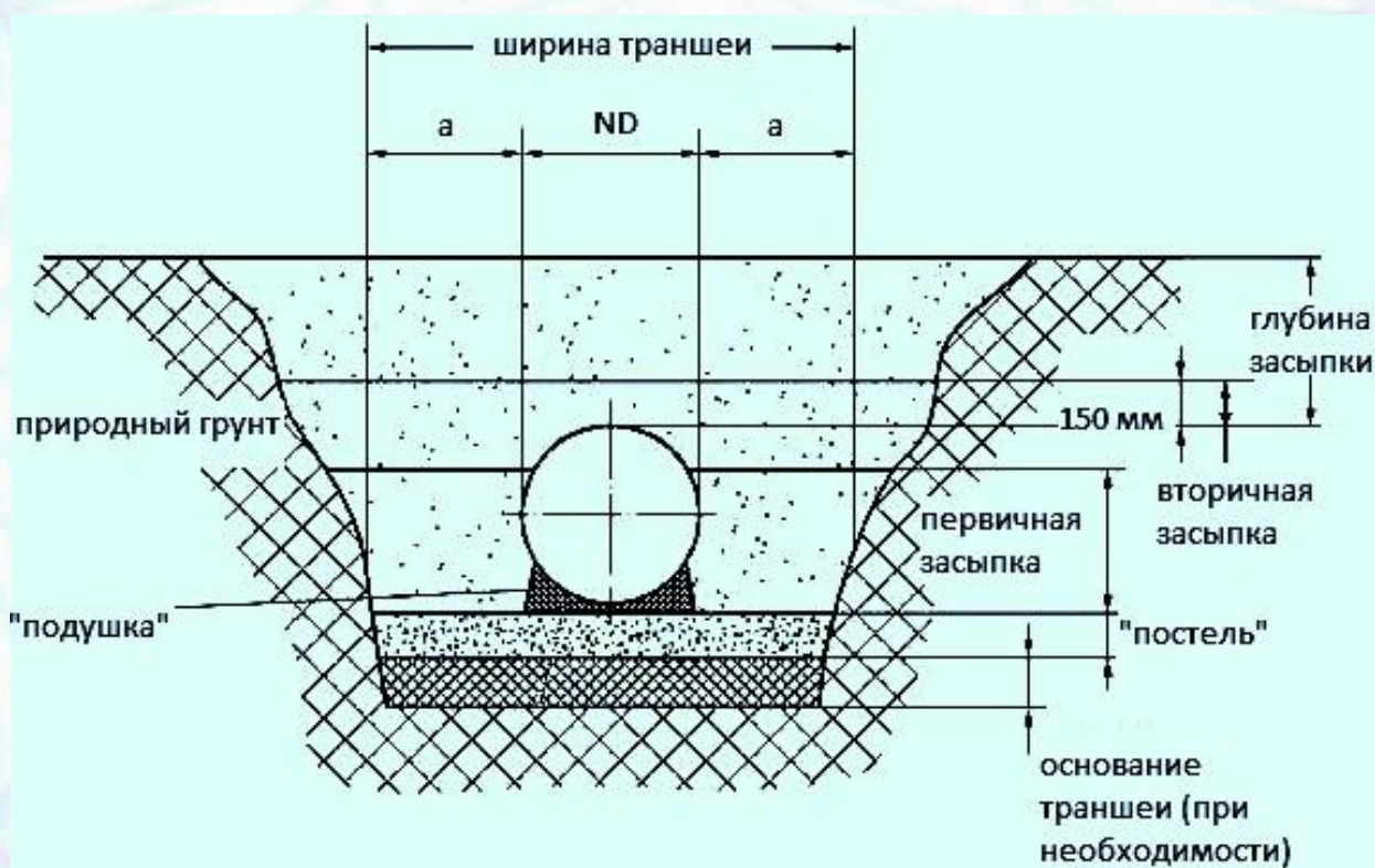
Рис.22 Схема укладки трубы в грунт
