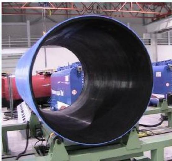
Рис. 10 Заготовка для технологической ёмкости Е12.ШЭП - труба трёхслойная цилиндрическая
