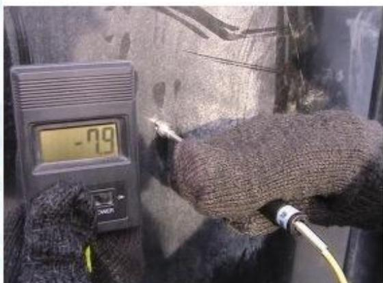
фото 5.  $T^{\circ}\text{C}$  торцевой стенки ёмкости  $-7,9^{\circ}\text{C}$
