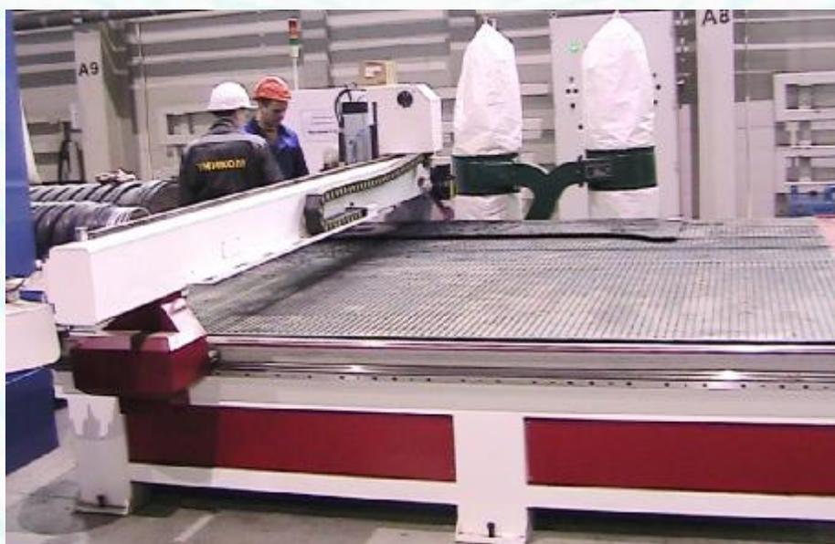
Рис. 6 Раскрой листовых элементов резервуаров на вертикально-фрезерном станке с ЧПУ
