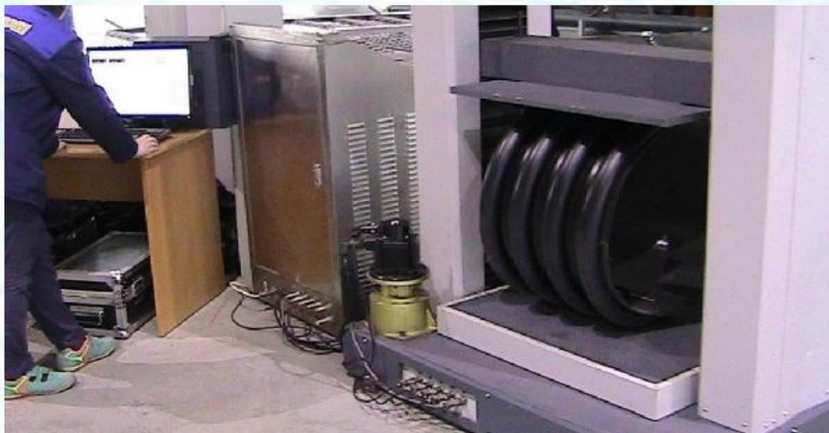
**Рис.22** Определение класса кольцевой жёсткости
