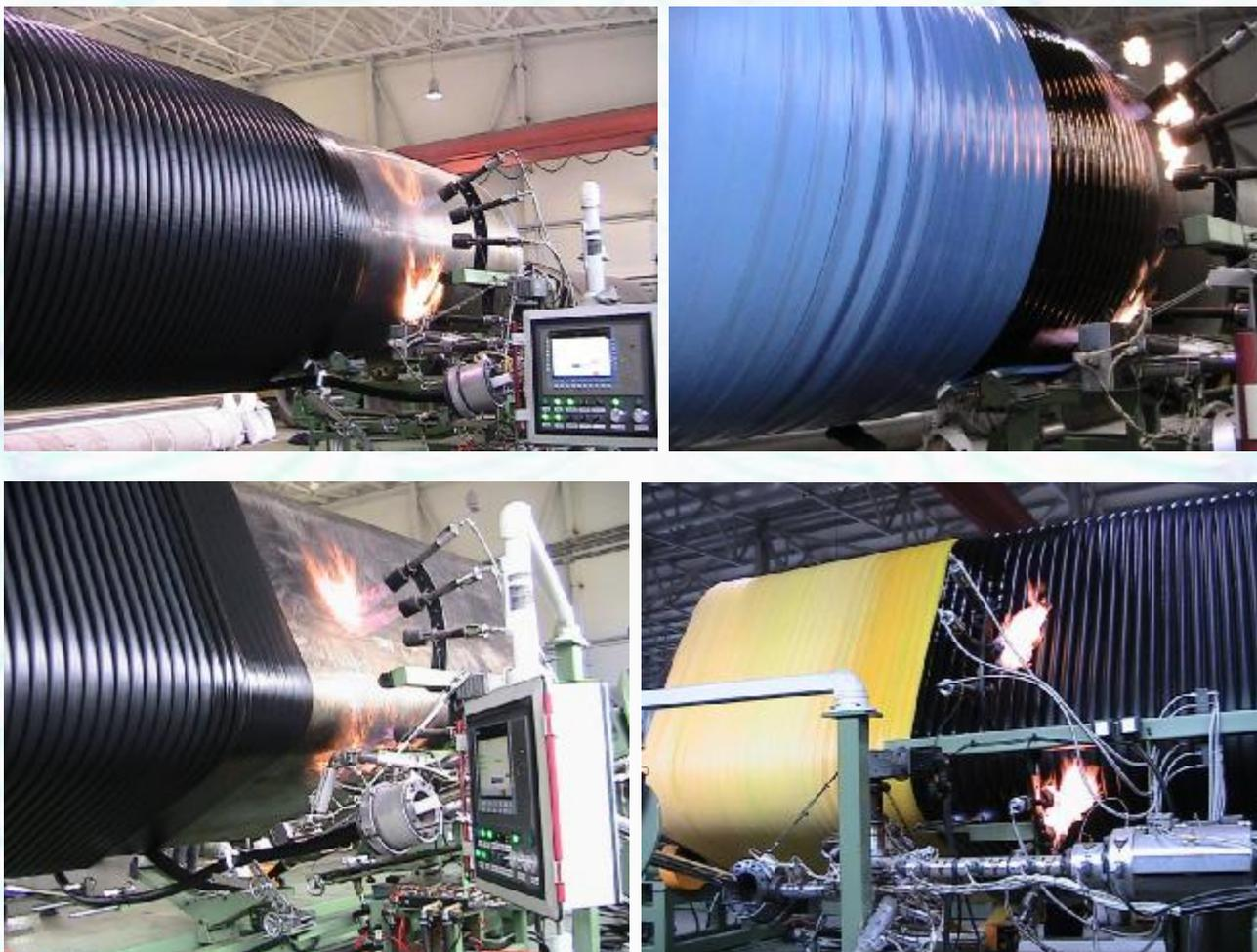
Рис. 5 Изготовление трёхслойных труб для ёмкостей круглого и квадратного сечения
