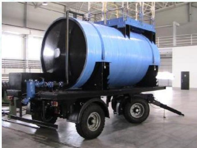
Рис. 11 Ёмкость технологическая Е12.ШЭП для солевых растворов
