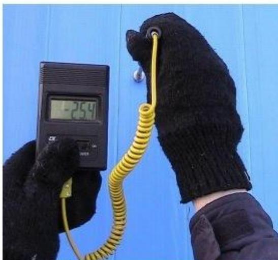
фото 6.  $T^{\circ}\text{C}$  боковой стенки ёмкости  $-25,4^{\circ}\text{C}$
