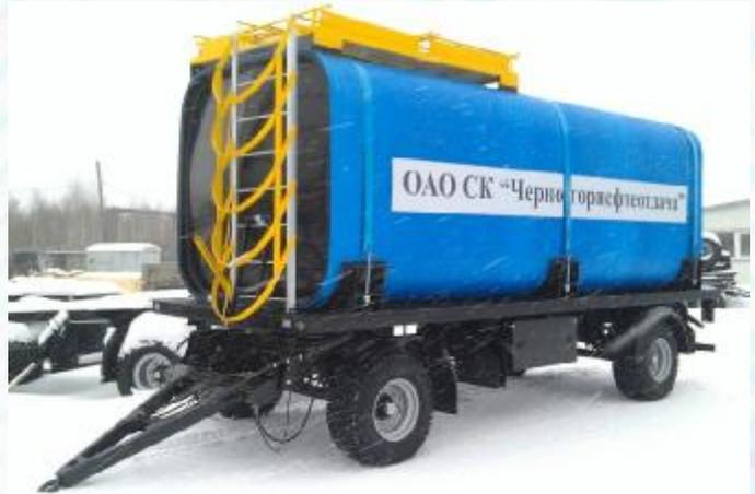
Рис. 14 Ёмкость технологическая ET-25.ОПШ V=25 м.куб.
