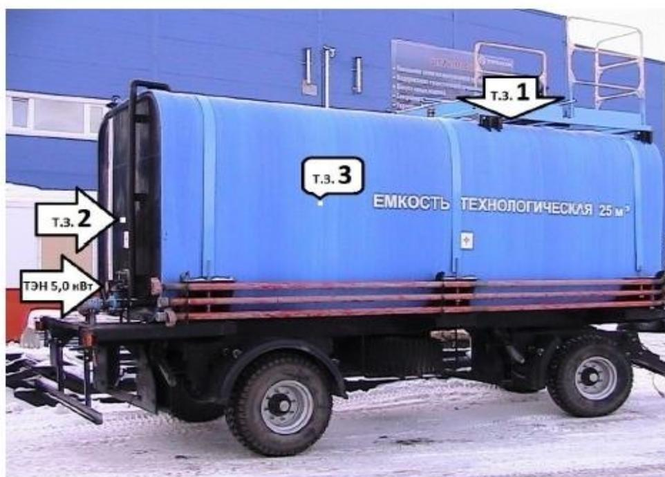
фото 1. т.з.1, т.з.2, т.з.3 – точки замеров температуры
