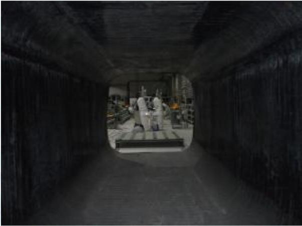
Рис. 13 Заготовка для технологической ёмкости ET-25.ОПШ квадратного сечения – вид изнутри
